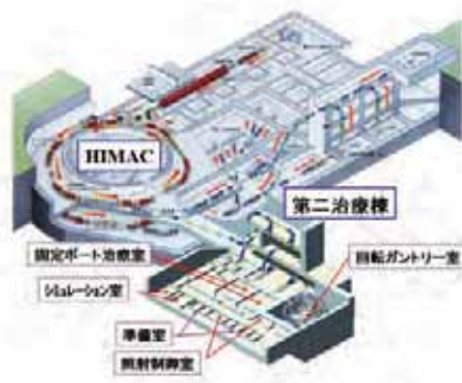
図3. HIMAC棟の全景。本棟(3治療室)ではブロードビーム照射法、第2治療棟ではスキャンニング照射法が行われている。
