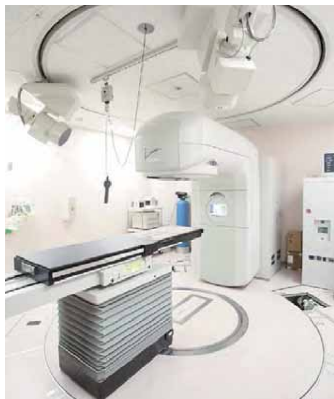
放射線治療時の「目」となるエックス線透視装置は島津製作所製。
