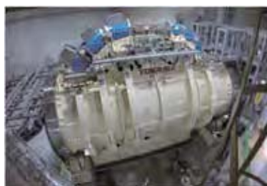
回転ガントリー装置 (量研/放射線医学総合研究所納品)
