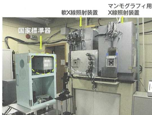
図1：産総研の軟X線及びマンモグラフィX線用線量計の校正施設
