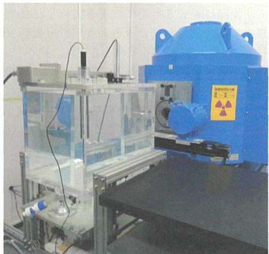
図3：水中校正の様子(電離箱は二次標準器)
