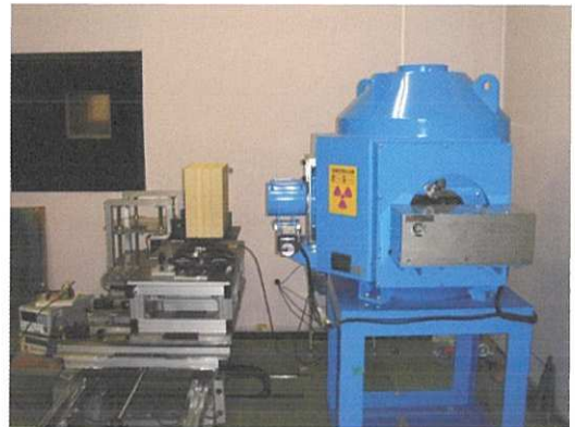
図4：放医研での標準素子照射風景。ガラス封入ファントムを挟みます
