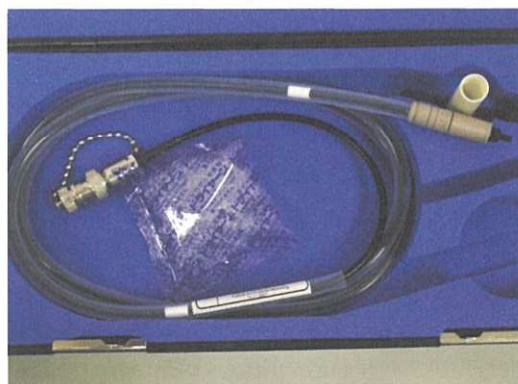
図2：スキャンデータ測定用電離箱IBA CC01の外観図
