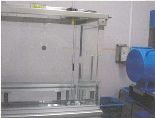
図6：放医研のコバルト照射装置によるIAEAのTLD照射風景。中空の亚克力製の筒を放医研所持の水槽の中に沈めて、水が入り込んだ筒の中にTLDの入った容器を上から落としてセッティングします
