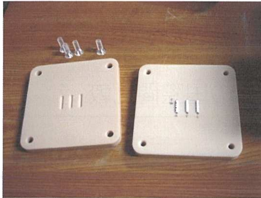
図3：ガラス線量計（カプセルに入った状態。このようにファントムに挟み込まれる。）
