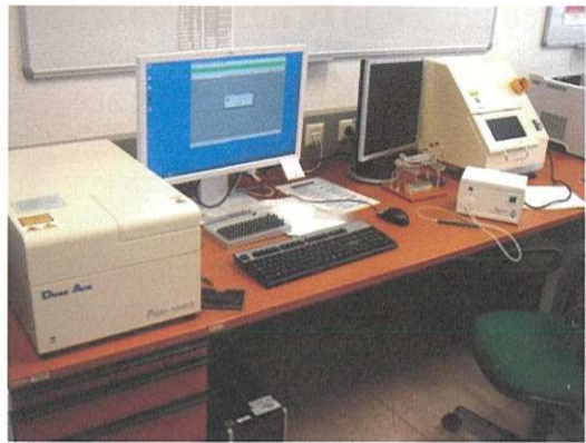
図8：IAEAに導入された蛍光ガラス線量計システム
