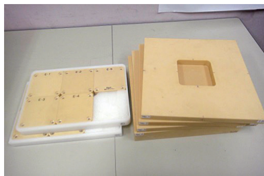
図1：測定ピース(左)とタフウォータファントム(右) タフウォータファントム最上段が穴開きファントム
