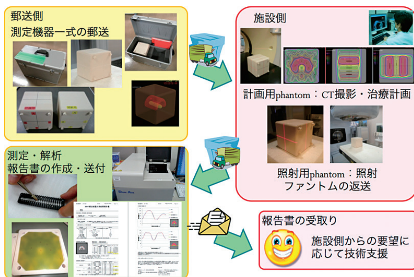
図3：郵送IMRT 第三者出力線量評価システムの概要
