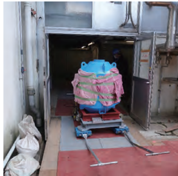
重機吊り器で吊り上げ、電動台車で運び出し、クレーンでトラックに積み込みます。新線源装填後は逆の手順で搬入します。
