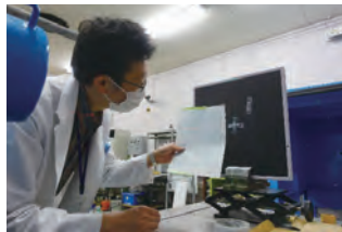
IPおよびガフクロミックフィルムを使用した軸調整・照射野確認作業
