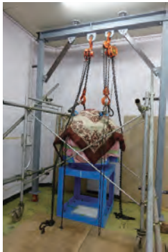
重機吊り器で吊り上げ、電動台車で運び出し、クレーンでトラックに積み込みます。新線源装填後は逆の手順で搬入します。
