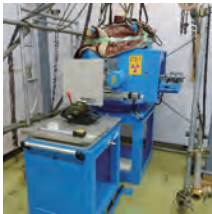
IPおよびガフクロミックフィルムを使用した軸調整・照射野確認作業
